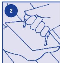
**2. APPLIQUER :** Appliquer le Timbermate juste avant le ponçage final avec une truelle en plastique ou une raclette en caoutchouc en travers du grain sur tout le plancher. S'assurer que le bouche-pores pénètre bien dans les cavités profondes. Ne pas appliquer Timbermate trop libéralement – une petite quantité couvre une grande surface. Enlever l'excédent de Timbermate. (Retourner l'excédent de Timbermate au pot – pas de gaspillage)
