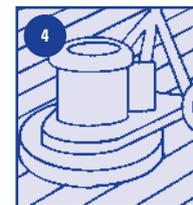
**4. PONCER :** Passer un dernier coup de ponceuse et retirer la poussière et les débris. (REMARQUE : Ne pas utiliser un grain abrasif de plus de 120).
