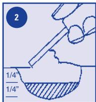
**2. REMPLIR :** Si le trou fait plus de 6 mm, remplir en appliquant des couches de Timbermate de 6 mm à la fois.
